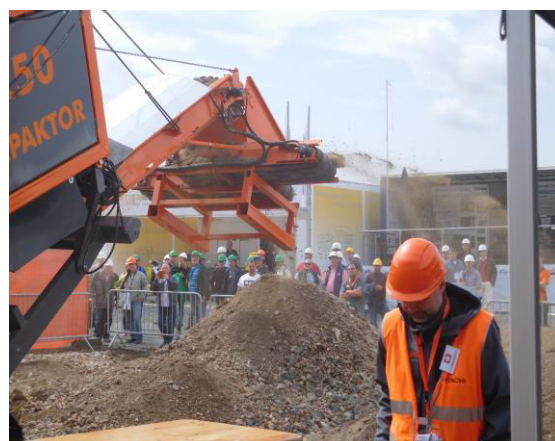
Слика 14.4-3. Машина/постројење за третман отпада од грађења и рушења (дробилица, магнетни сепаратор - слика лево и сито на крају конвејера (слика десно)
