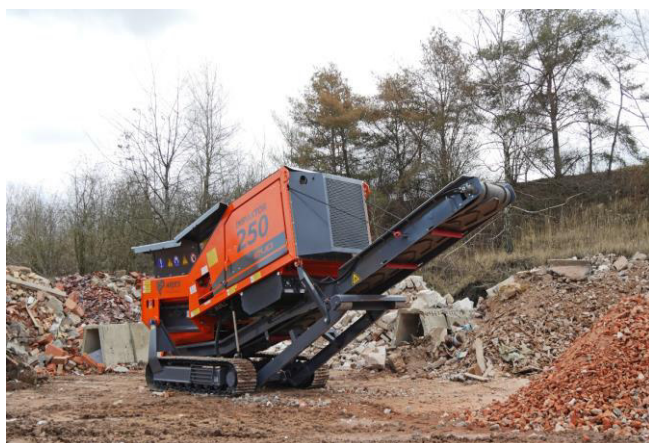
Слика 14.4-3. Машина/постројење за третман отпада од грађења и рушења (дробилица, магнетни сепаратор - слика лево и сито на крају конвејера (слика десно)
